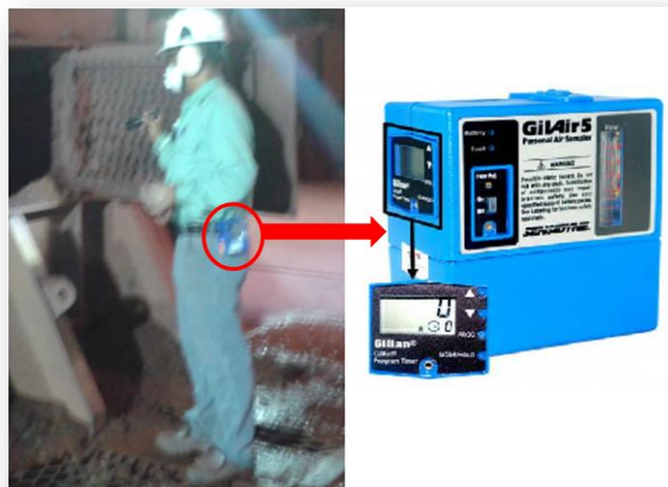
Figura 3 - Paradigma portando bomba de amostragem programável mod. GILAIR-5
