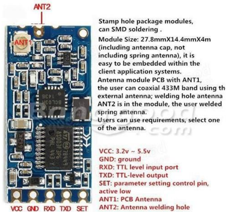
Figura 16. Características técnicas Módulo Inalámbrico
