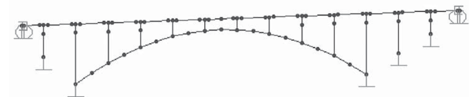
Figura 10. Modelo analítico del puente VG
