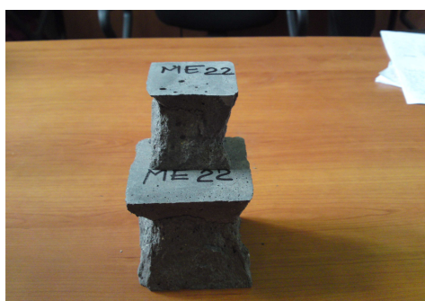
Cuburi de 50 și 71 mm (beton simplu) încercate la 6 zile
