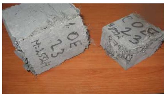
Cuburi de 50 și 100 mm (armate cu fibre) încercat la vârsta de 6 zile
