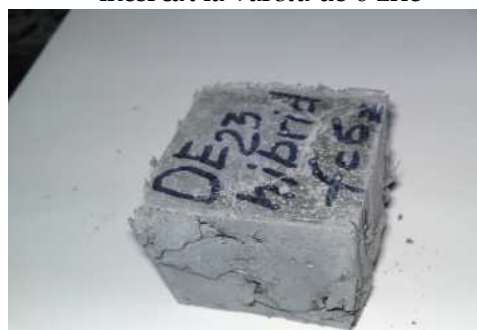
Cub de 100 mm (armat cu fibre) încercat la vârsta de 6 zile
