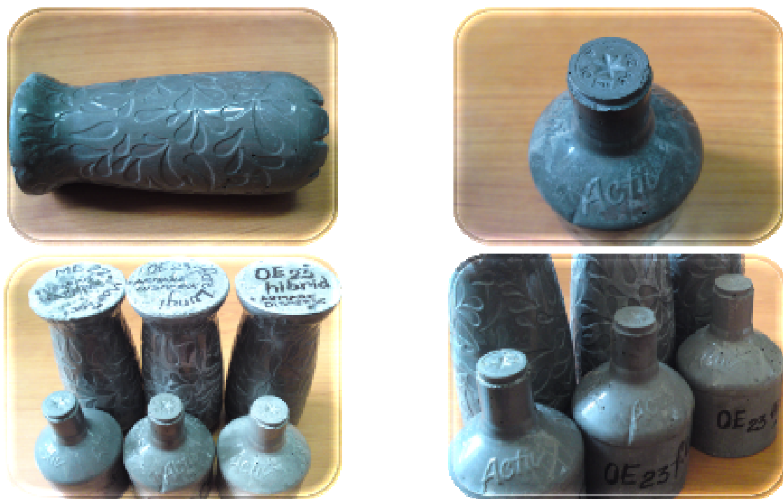
Fig. 5. Aspectul betonului prelevat în forme de plastic (Corbu, 2011)
