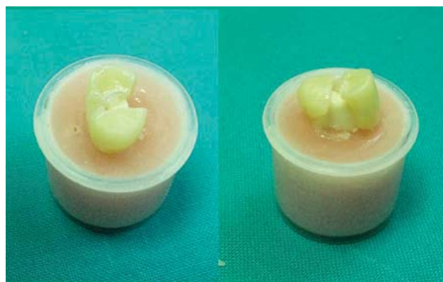
Sl. 8 – Lom keramičke krunice pod dejstvom opterećenja
