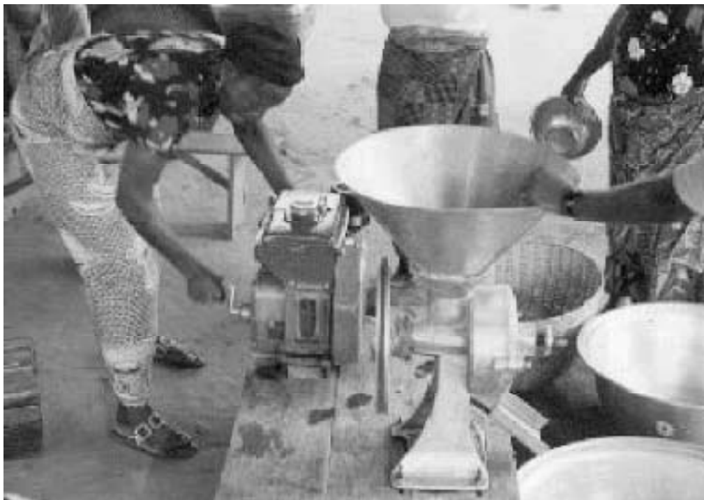
Photo 1: Mouture de tomate dans le moulin ASIKA A11 VIKING. (Photo M. Montcho).
