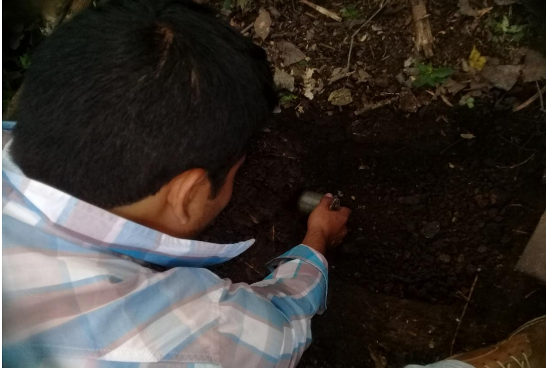
Anexo 32: Fotografía del muestreo del suelo con el método del cilindro para estimar su densidad
