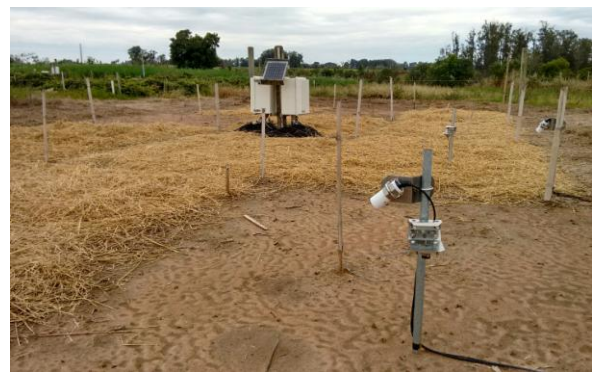
Figura 1 - Experimento montado na área experimental de Departamento de Solos da Universidade Federal de Santa Maria. Na figura as parcelas com e sem cobertura de palha lado a lado
