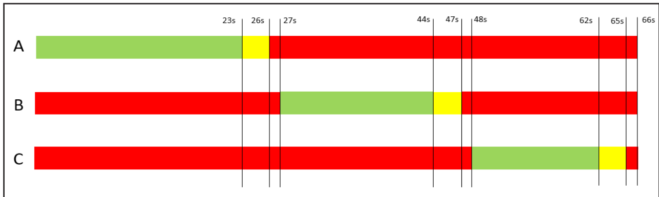
Figura 7 - Diagrama de barras da programação semafórica proposta para a interseção estudada na disciplina de Engenharia de Tráfego II
