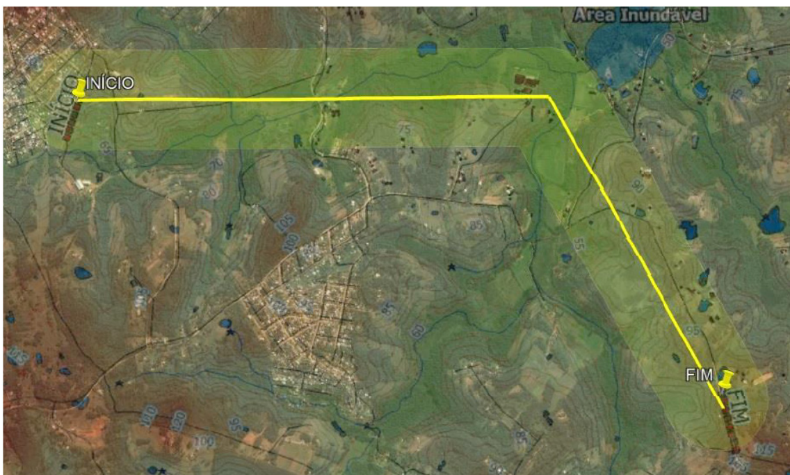
Figura 2 - Diretriz provisória do traçado de trecho rodoviário com buffer de 250m apresentado em Audiência Pública simulada na disciplina de Projeto Geométrico de Rodovias
