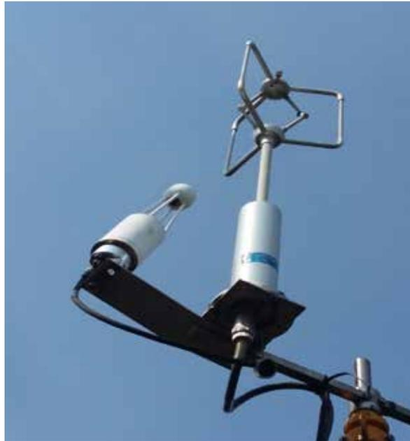
Figura 2 – Anemômetro sônico tridimensional (a) e analisador de gás por infravermelho de caminho aberto (b) instalados a 63,5 m de altura
