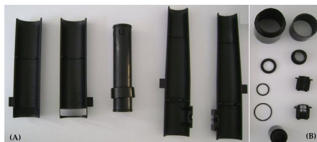
Figura 02 – Kit de montagem do Galileoscópio, (A) tubo e (B) jogo de lentes.
