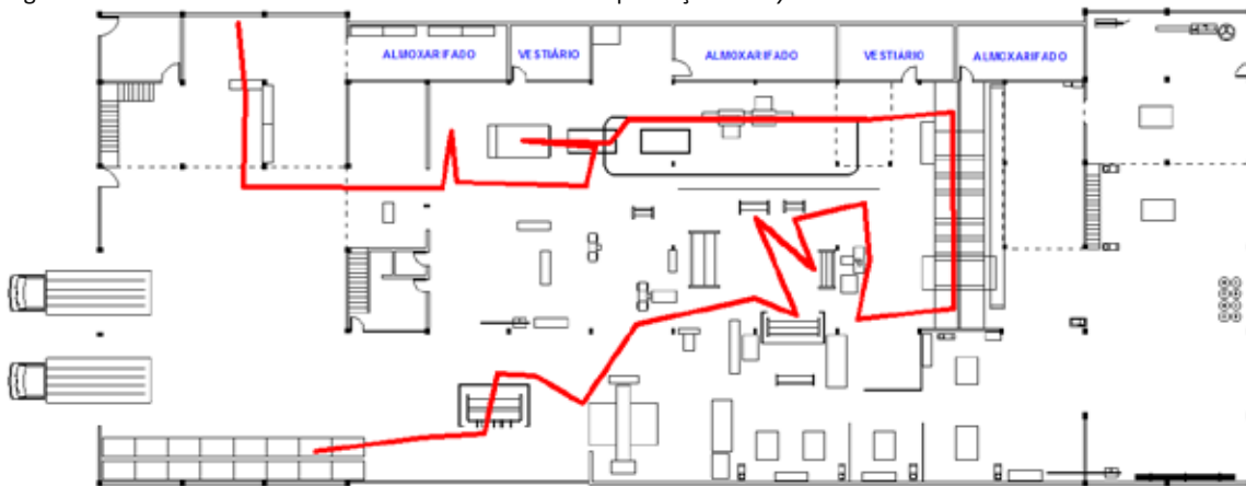
Figura 3 – Fluxo da família de itens com maior volume de produção no layout atual
