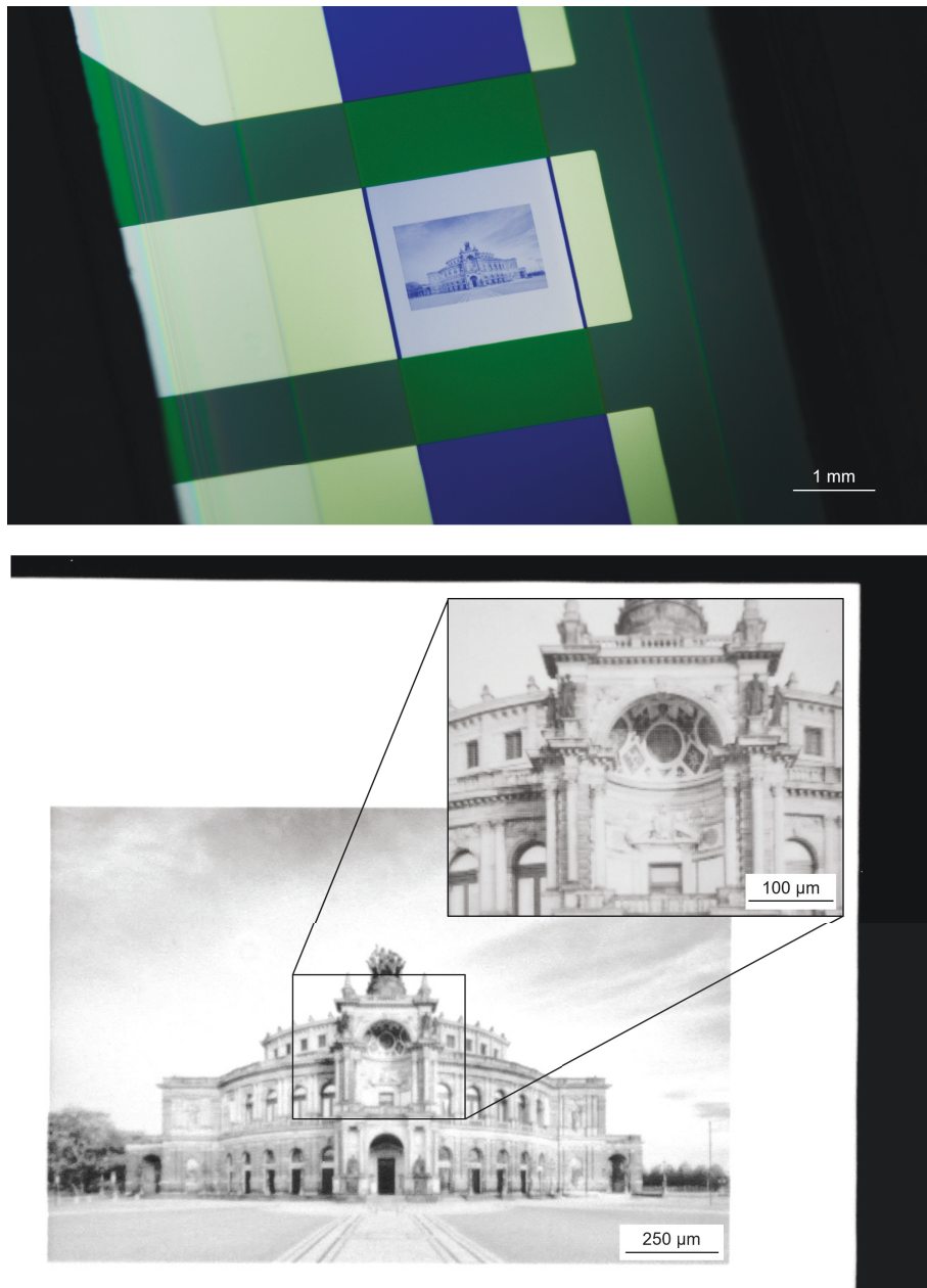
Abbildung 5.23: Testchip mit leuchtender OLED-Fläche und elektronenstrahlstrukturiertem Graustufenbild der Semperoper Dresden. Jeder Punkt des Bildes ist mit einer dem gewünschten Grauwert entsprechenden Elektronendosis geschrieben.
