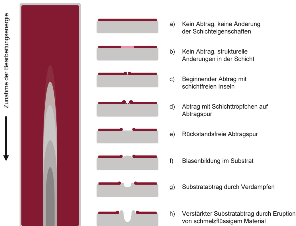
Abbildung 2.21: Effekte der Elektronenstrahlbearbeitung dünner Schichten mit zunehmender Bearbeitungsenergie, nach [SHP76].
