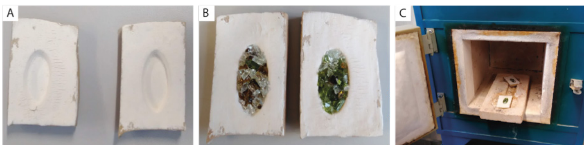
Figura 5 – Primeiro teste: (A) moldes pulverizados com um pouco de caulim; (B) pedaços de vidro acoplados no molde; (C) moldes com os rejeitos de vidro colocados no forno
