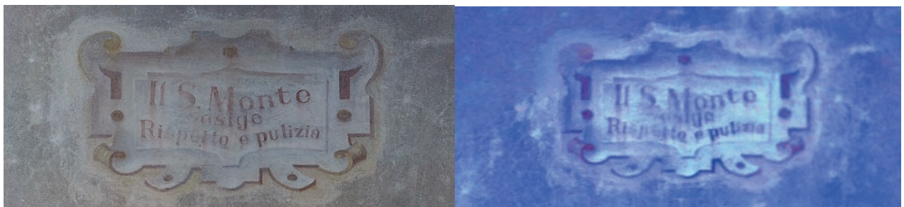
Figura 10 – Particolare di una porzione dell'ortofoto della cappella 10, si nota la maggiore risoluzione del dettaglio derivato dal dataset aereo/terrestre (sinistra) rispetto a quello derivato dal dataset della feature tracker camera (destra).
