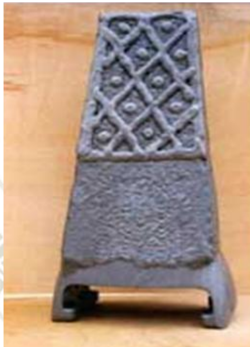
Figura 2-34 - Recargue de soldadura en uña de excavadora hidráulica [6]
