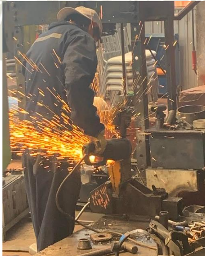
Figura 3-36 - Corte con disco Manual [1]
