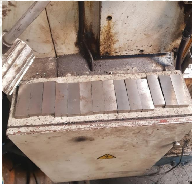
Figura 3-38 - Probetas de desgaste de Acero 32MnCrMo6-4-3 culminadas según la norma ASTM G65-16 [1]
