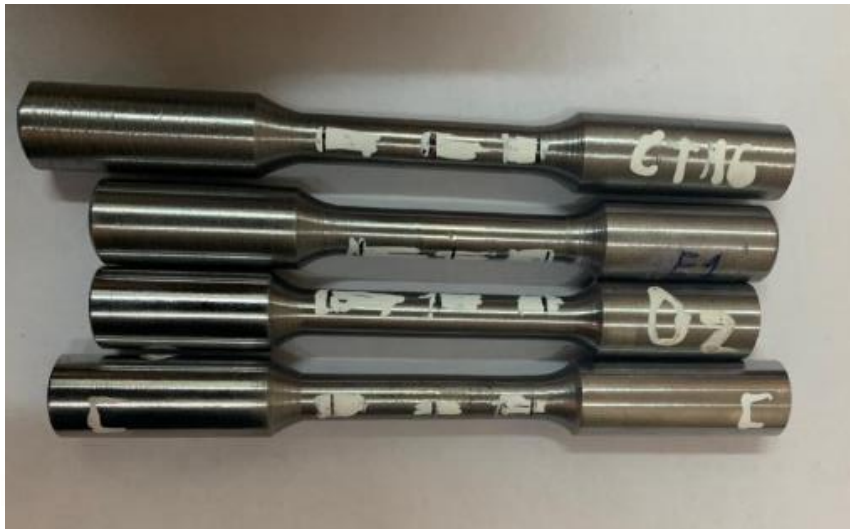
Figura 3-42 - Probetas de Tracción de Acero 32MnCrMo6-4-3 culminadas según la norma ASTM A370 – 18 [1]
