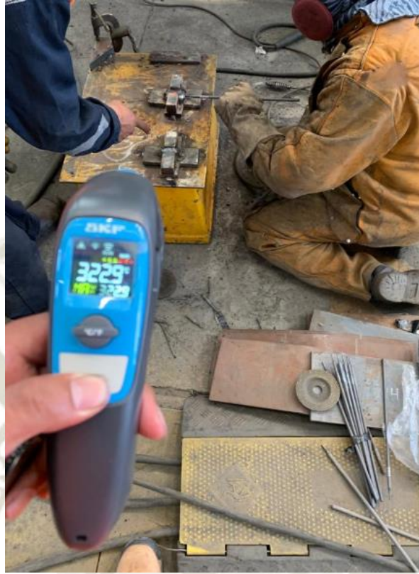
Figura 3-58 - Monitoreo de la soldadura de Recargue sobre el material base (Tracción), utilizando pirómetro SKF modelo TKTL 10 [1]
