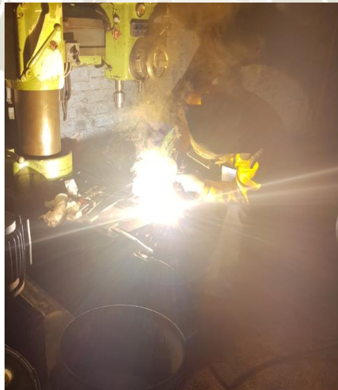
Figura 3-55 - Aplicación de soldadura de Recargue sobre el material base (Desgaste) [1]
