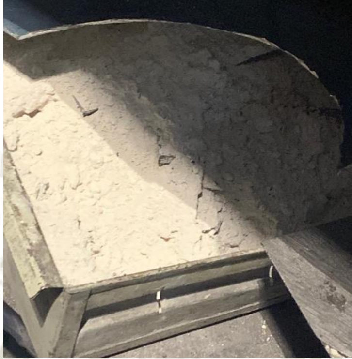
Figura 3-62 - Probetas de tracción con recargue en recipiente con cal industrial [1]
