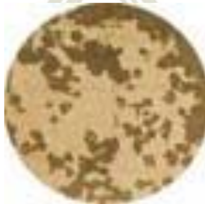
Figura 2-33 - Fotomicrografía carburos dispersos [10]
