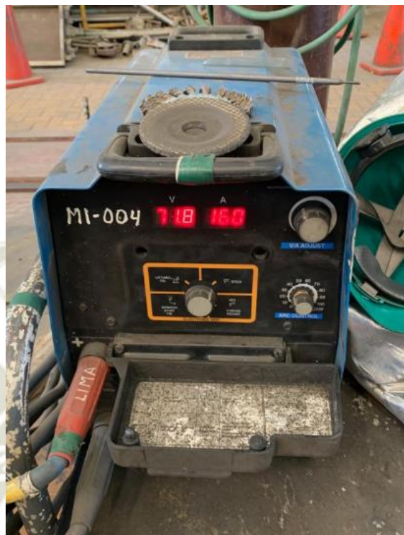
Figura 3-48 - Máquina de soldar multiproceso Miller XMT 425 SERIES – 160 A [1]
