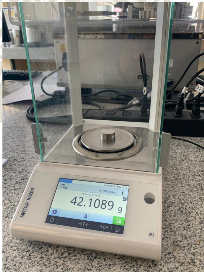
Figura 3-81 - Pesaje en balanza de probetas de desgaste [1]
