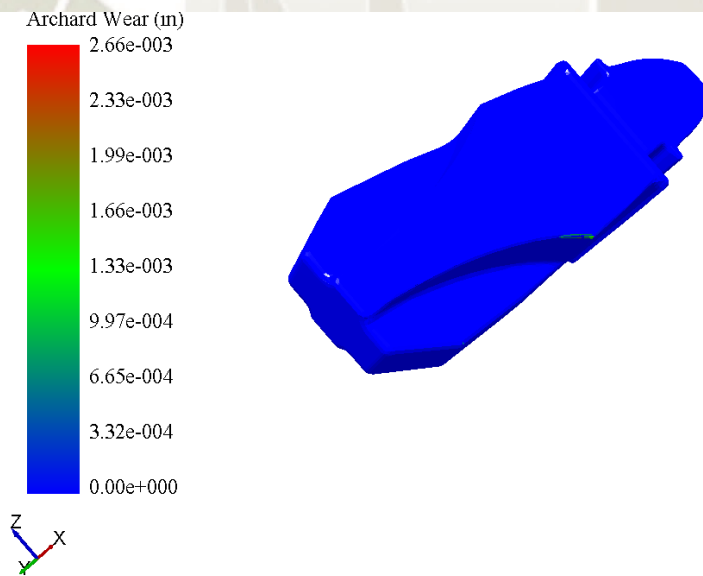
Figura 4-29 - Simulación de desgaste EDEM – Material Citodur – 1000 [1]
