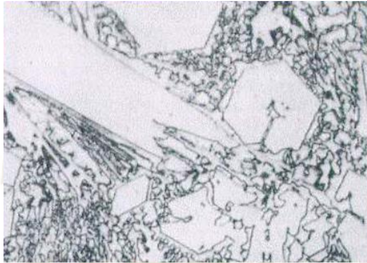
Figura 2-32 - Fotomicrografía Carburos en Red [10]
