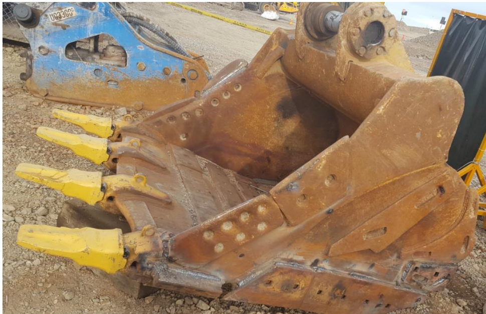
Figura 3-45 - Cucharon de excavadora 336D2 L con 04 uñas de Acero 32MnCrMo6-4-3 [1]
