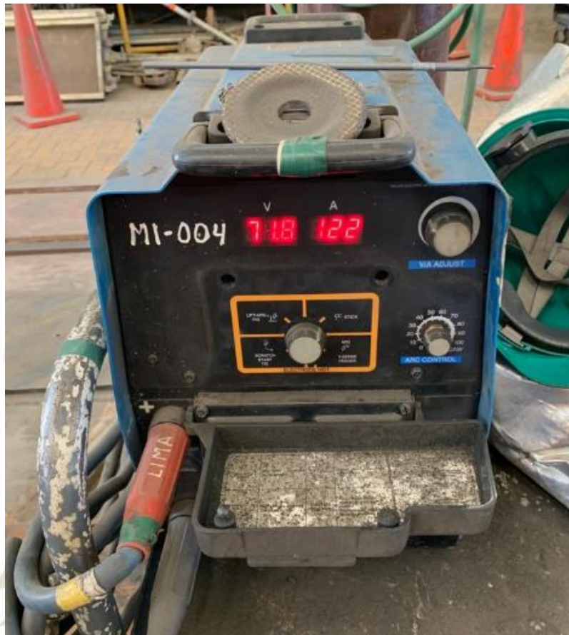
Figura 3-50 - Máquina de soldar multiproceso Miller XMT 425 SERIES – 122 A [1]
