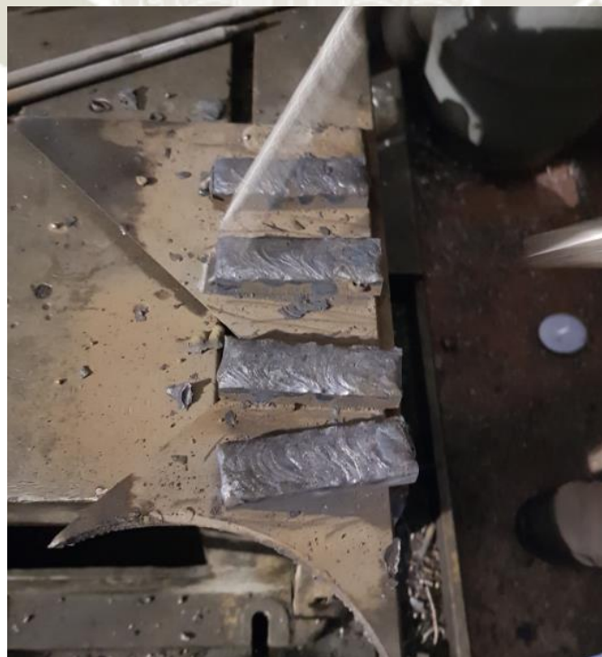
Figura 3-58 - Monitoreo de la soldadura de Recargue sobre el material base (Tracción), utilizando pirómetro SKF modelo TKTL 10 [1]
