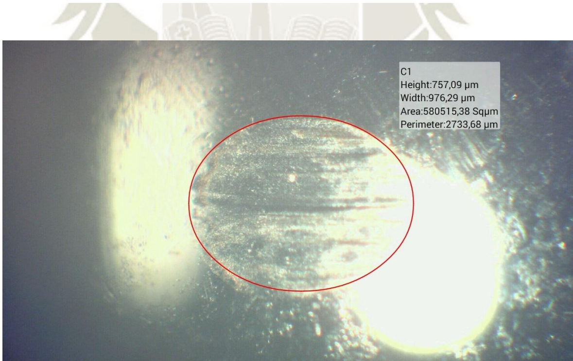
Figura 4-16 - Medida de pista de desgaste – Citodur – 1000 [1]
