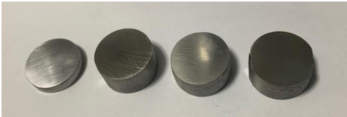
Figura 3-44 - Probetas de Desgaste de Acero 32MnCrMo6-4-3 después del recargue de Soladura Según la norma ASTM G-99 -17 [1]
