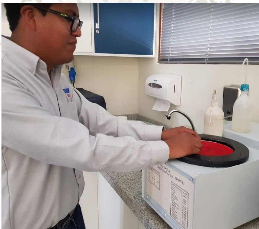
Figura 3-68 - Pulido de probetas para ensayo metalográficos [1]
