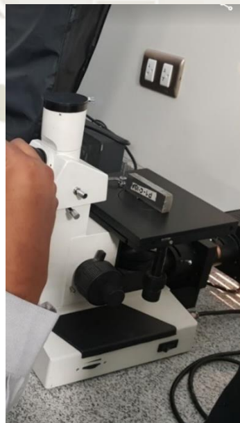
Figura 3-71 - Visualización de las microestructuras con el microscopio Metalúrgico Invertido Óptico, Time Group INC, DX40TV con una resolución 20x/100x [1]
