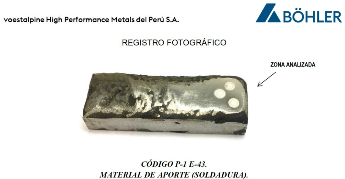
Figura 3-64 - Probeta con soldadura de recargue Exadur 43 (P1) [1]
