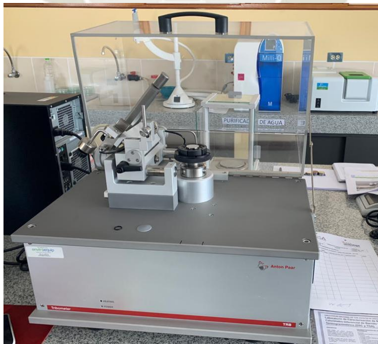
Figura 3-78 - Tribómetro marca ANTON PAAR modelo TRB3 [1]
