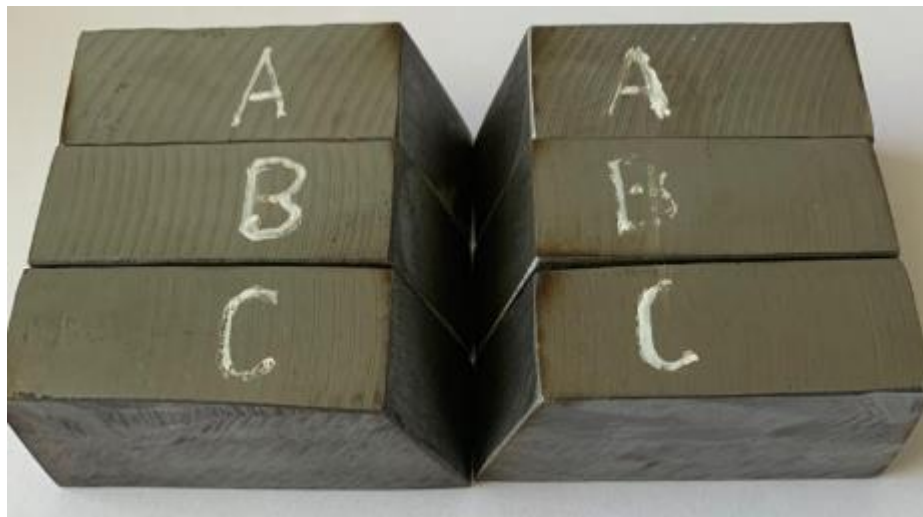
Figura 3-40 - Probetas de Tracción de Acero 32MnCrMo6-4-3 listos para la aplicación de soldadura [1]
