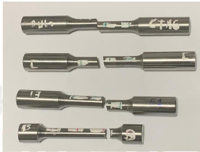
Figura 3-77 - Muestras de tracción ensayadas [1]
