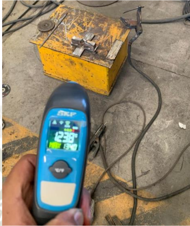
Figura 3-54 - Monitoreo del precalentamiento del metal base (Tracción), utilizando pirómetro SKF modelo TKTL 10 [1]
