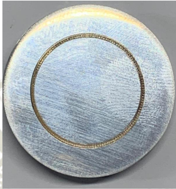
Figura 3-86 - Probeta de desgaste ensayada [1]
