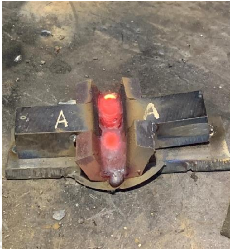
Figura 3-60 - Probeta de Tracción unido con soldadura de Recargue [1]
