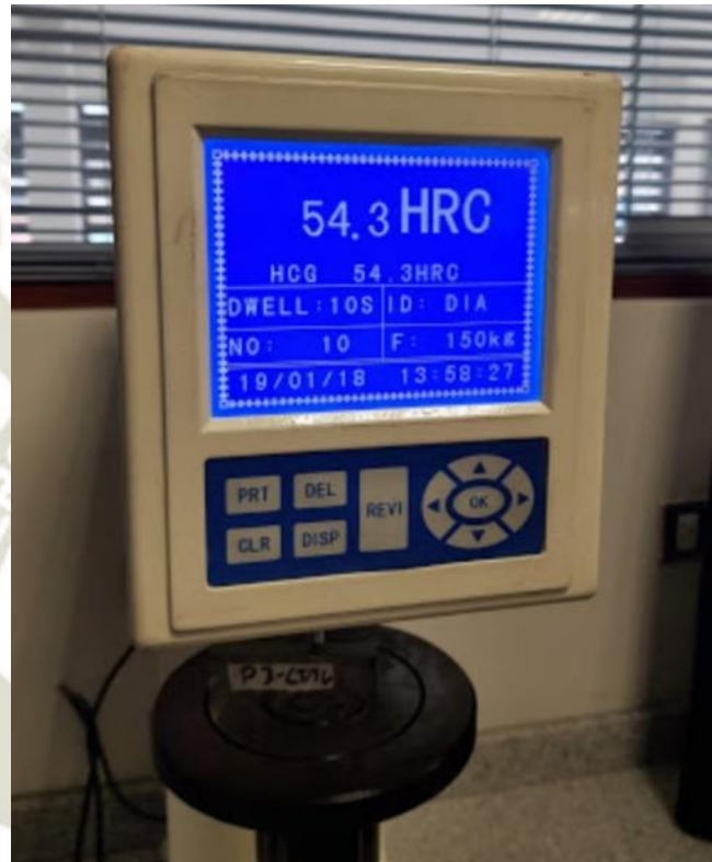
Figura 3-73 - Durómetro dureza Rockwell C, marca Time Group INC modelo HRC -150 [1]
