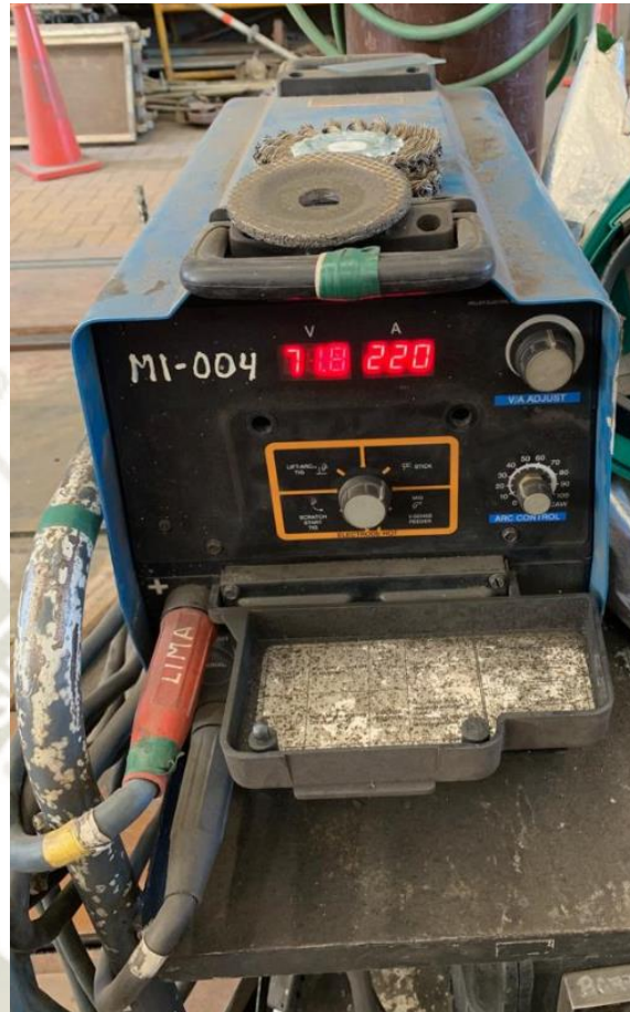
Figura 3-46 - Máquina de soldar multiproceso Miller XMT 425 SERIES, alimentación trifásica, de 5 a 425 A a 10 - 38 VCD [1]
