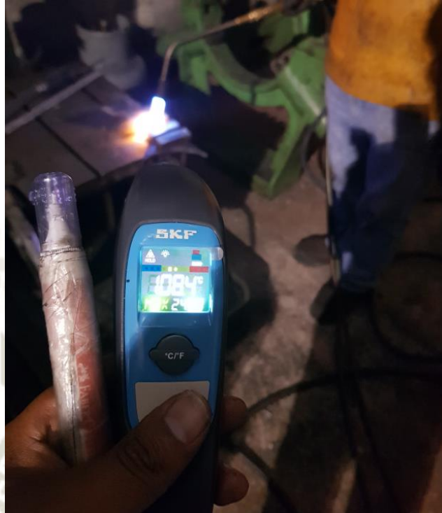
Figura 3-52 - Monitoreo del precalentamiento del metal base (Desgaste), utilizando pirómetro SKF modelo TKTL 10 [1]
