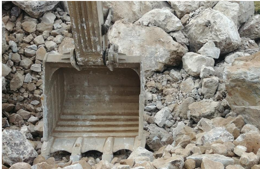
Figura 2-13 - Cucharón de excavadora desgarrado con material abrasivo [1]
