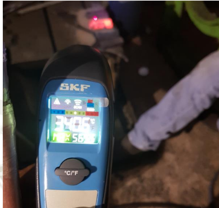
Figura 3-56 - Monitoreo de la soldadura de Recargue sobre el material base (Desgaste), utilizando pirómetro SKF modelo TKTL 10 [1]
