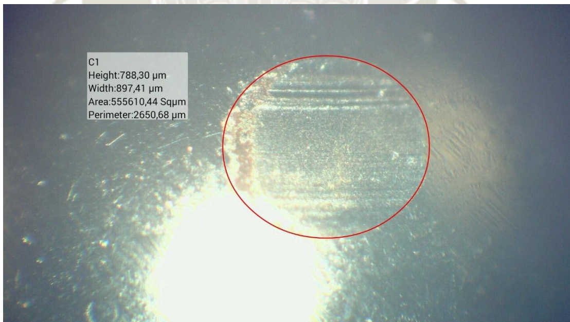
Figura 4-11 - Medida de desgaste Billa de WC con Material Base [1]
