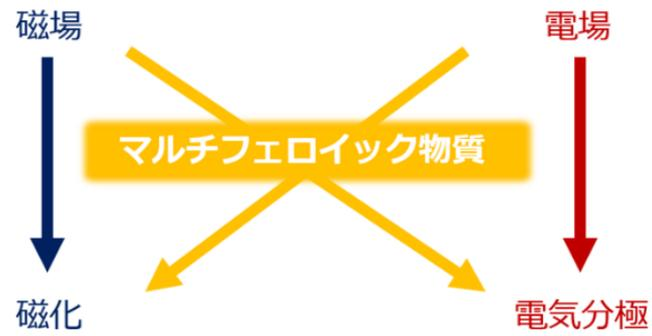
図 1-1 マルチフェロイック物質における電気磁気効果の概念図
