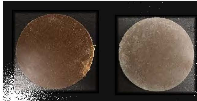
Figure 3.3 La surface de CBP non oxydée (à gauche) et oxydée (à droite).
