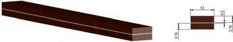
ASTM D 790 L'éprouvette de CBP pour la flexion à 3 points.
