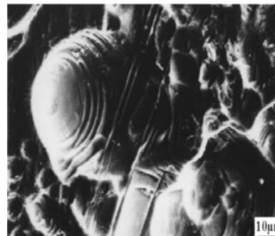
Obr. 9. SEM mikrogram. Koncentricky rýhované globulárne útvary na povrchu rýdzeho Sb po 18 dňoch biochemického leptania Fig. 9. SEM secondary electron image. Concentrically lined globular-shaped surface of the native Sb after 18 days of biological-chemical leaching.
