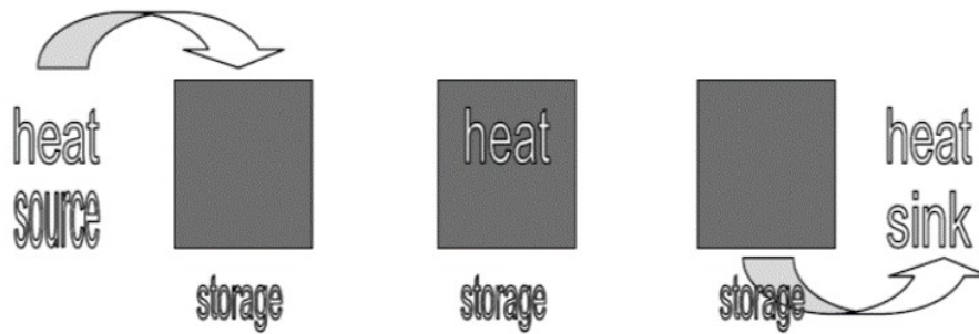
Figure 2.3-3 : Schéma de fonctionnement de base du stockage thermique [18]
