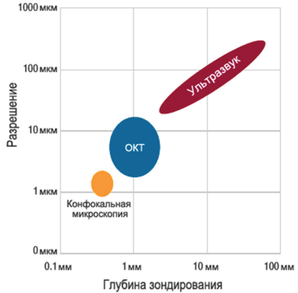
Рис. 2. Разрешающая способность и глубина зондирования биотканей для различных методов исследования кожи
