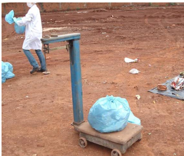
Figura 3 - Acondicionamento e pesagem de cada parcela de resíduos sólidos. Fonte: PGIRSU (2008).
