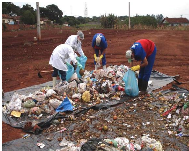
Figura 2 - Segregação manual das parcelas de resíduos sólidos. Fonte: PGIRSU (2008).
