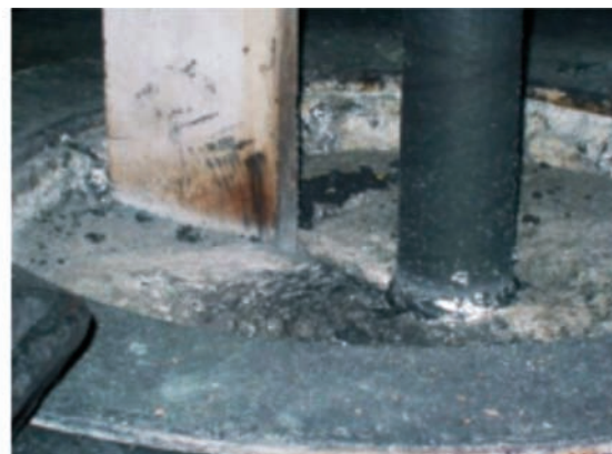
(d) Degassing process, 120–600 s, 350–500 rpm
