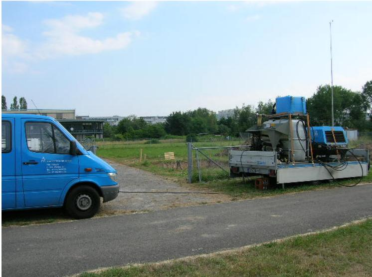
Abb. 15. Das ganze Bohrequipment (Mischanlage, Hydraulikstation, Bohrerät) der GRUNDOPIT-Anlage passt auf einen Kleintransporter samt Anhänger.
