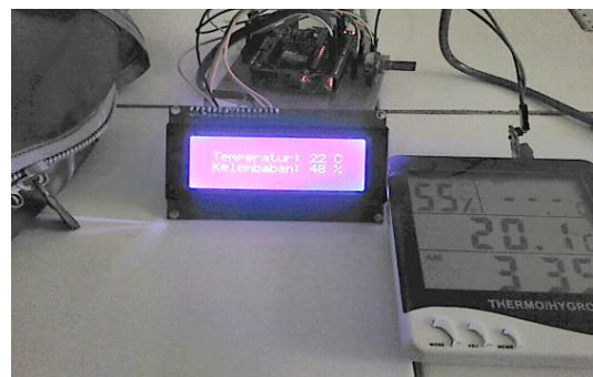
Gambar 6. Pengujian sensor DHT11
