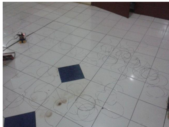
Gambar 7: Hasil eksperimen lintasan mobile robot dengan sistem kendali persamaan Generator Moore Spiegel.
