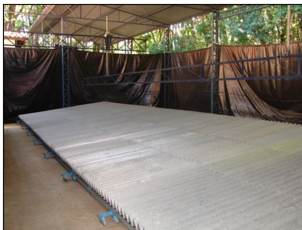
FIGURA 1. Bancada para análise da distribuição transversal de barras de pulverização.
