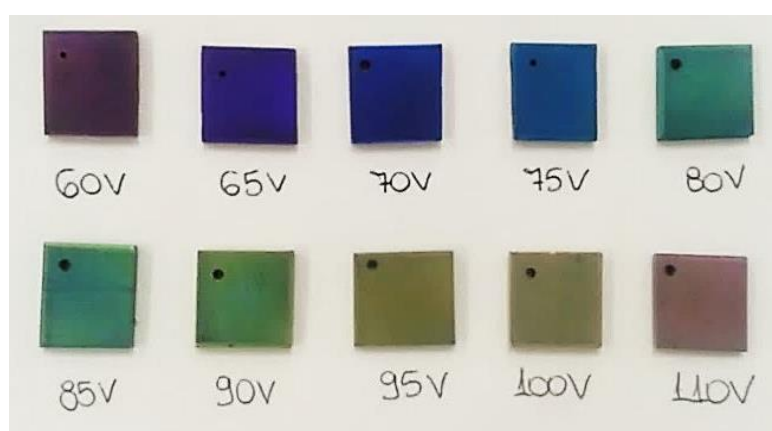
Figura 1 - Resultado do processo de anodização aplicada a chapas de Nióbio em diferentes voltagens.
