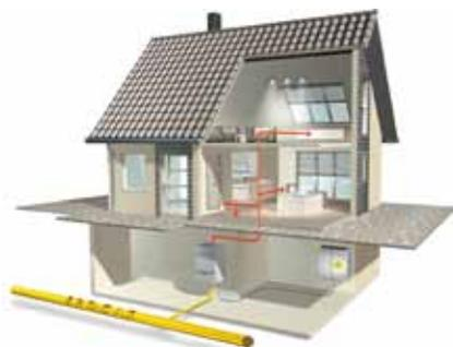
enviaM setzt auf die Vorteile einer Erdgas-Brennwerttherme: Die Wärmeenergie heißer Verbrennungsdämpfe wird in zusätzliche Heizwärme umgewandelt. Dadurch erweist sie sich als sehr effizientes und kostensparendes System.
