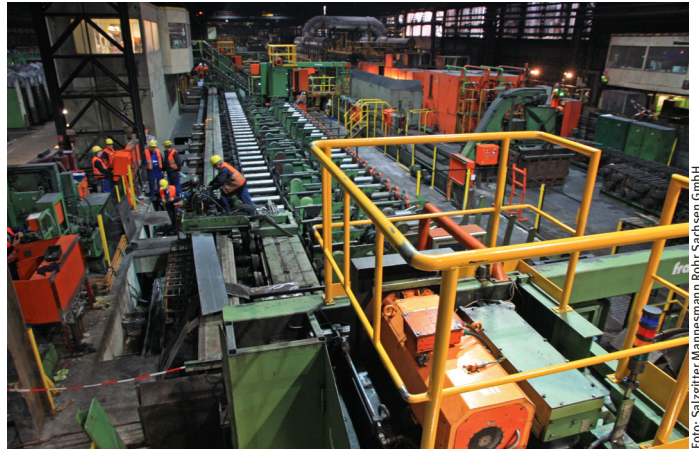
Das Automatisierungssystem der Trennanlage wurde erneuert. In der Anlage können Rohrstränge von vier bis 22 Meter geschnitten werden.
