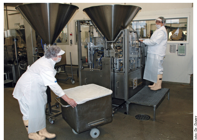
Eine neue Abfüllanlage mit besonders schnellem Reinigungssystem macht einen zügigen Sortenwechsel möglich. Die Herstellung kleinerer Mengen wird bei der Dr. Doerr Feinkost GmbH nun rentabel.
