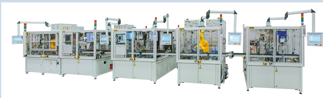
Montageanlage für Drucksensoren. Bild rechts: Sensormontage mit Produktdatenverfolgung.
