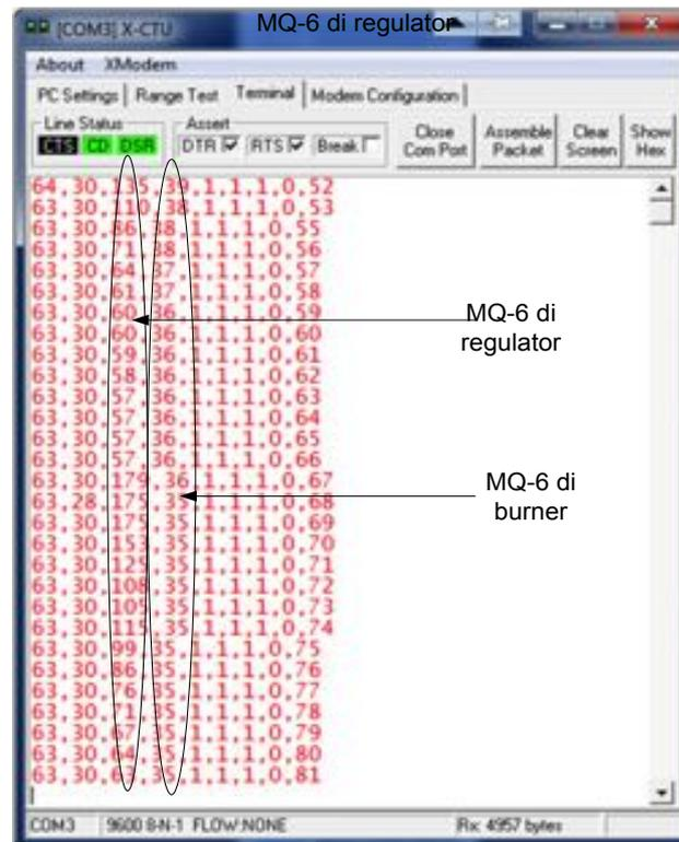
Gambar 8. Data konversi ADC dari sinyal *output* MQ – 6
