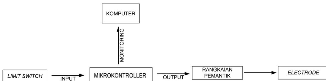
Gambar 11. Diagram blok pengujian pemantik otomatis
