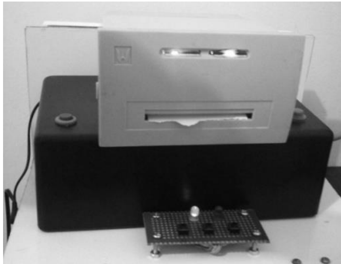
Gambar 9. Mesin kartu antrian Berbasis Mikrokontroler ATmega16A
