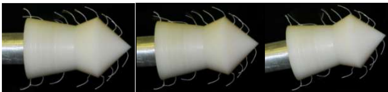
Рис. 6. Обтекание модели пули б) дозвуковым потоком при различных углах атаки.
