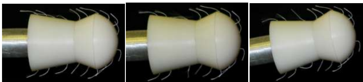
Рис. 7. Обтекание модели пули в) дозвуковым потоком при различных углах атаки.
