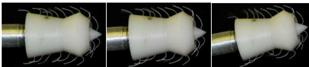
Рис. 9. Обтекание модели пули е) дозвуковым потоком при различных углах атаки.
