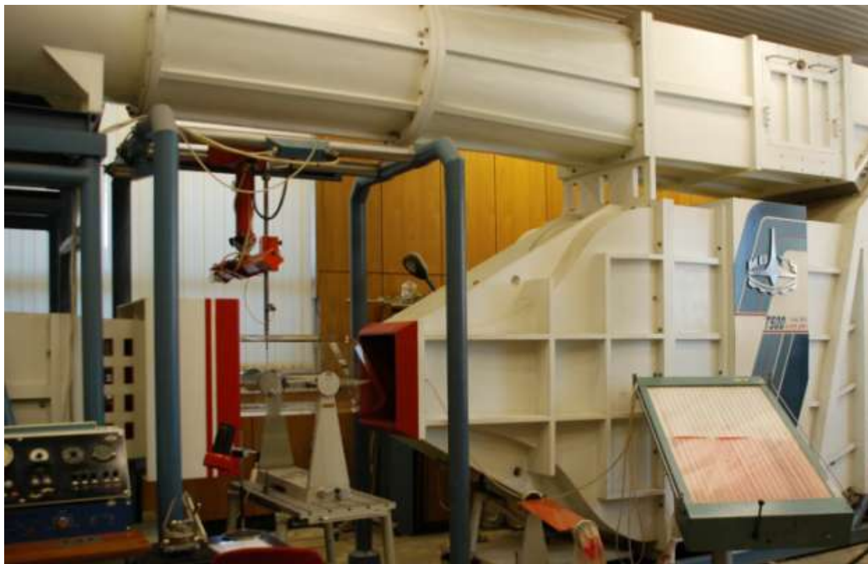
Рис. 4. Рабочая часть дозвуковой аэродинамической трубы
