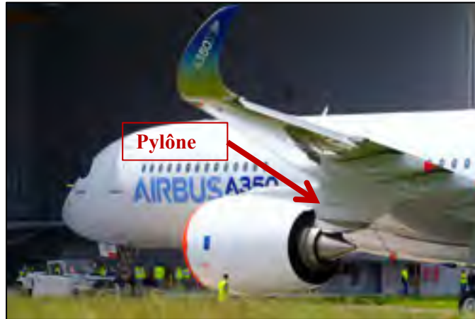
Figure 3.1 : Emplacement du Pylône sur un A350
