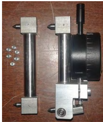
Figure 2-15. Plots d'extensométrie, barre étalon et extensomètre à pointeaux (de droite à gauche)
