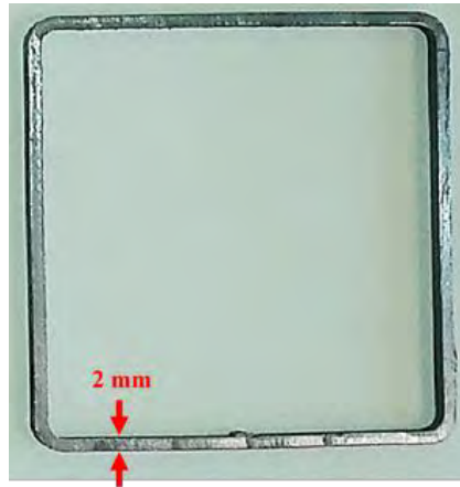
Figure 2-2. Plats transversaux en acier inoxydable ( 100 \times 100 \times 5 mm, ép. 2 mm).
