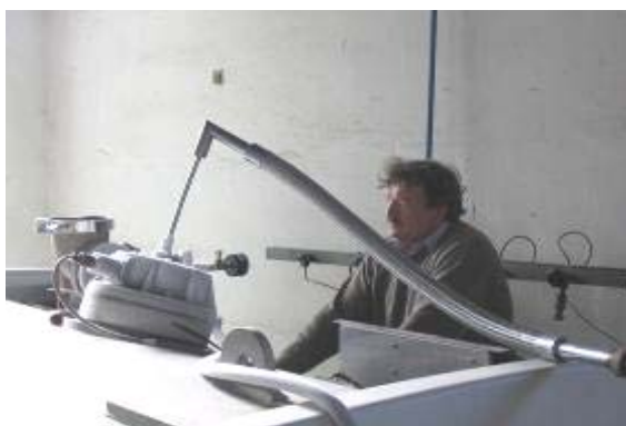
Obr. 9. Predchladzovanie magnetu tekutým N. Fig. 9. Overcooling process of magnet by liquid nitrogen.
