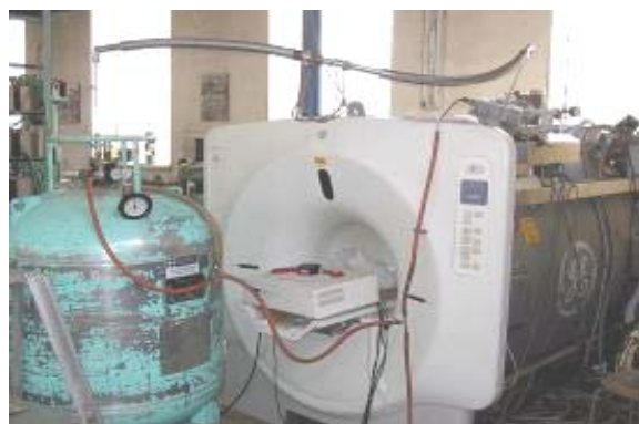
Obr. 10. Pozvoľné zalievanie magnetu tekutým He. Fig. 10. Refilling of superconducting magnet with He.
