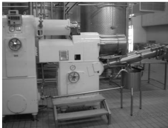
Slika 1. Mašina za kontinuiranu proizvodnju maslaca / Figure 1. Machine for continuous production of butter
