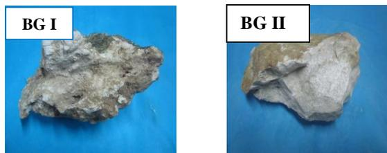
**Gambar 2.** Sampel batuan gamping BG I dan BG II sebelum dilakukan destruksi dan pencucian
