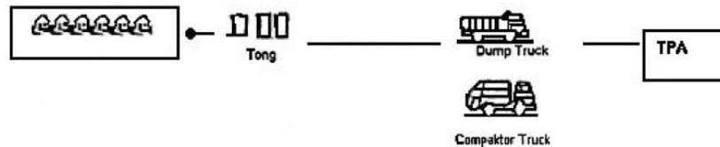
**Gambar 2.7** Pola Pengangkutan Sampah Sistem Individual Langsung
