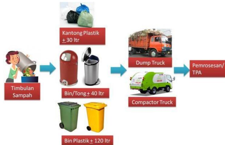
**Gambar 2.6.** Pola Pengangkutan Sampah Sistem Individual Langsung
