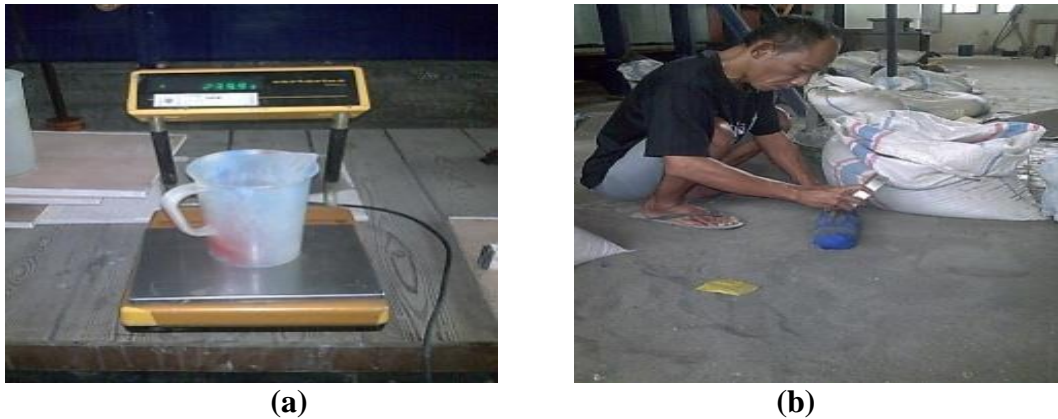
Gambar 3. (a). Pengukuran berat pasir pengisi, (b). Pengisian pasir ke dalam geotube .
