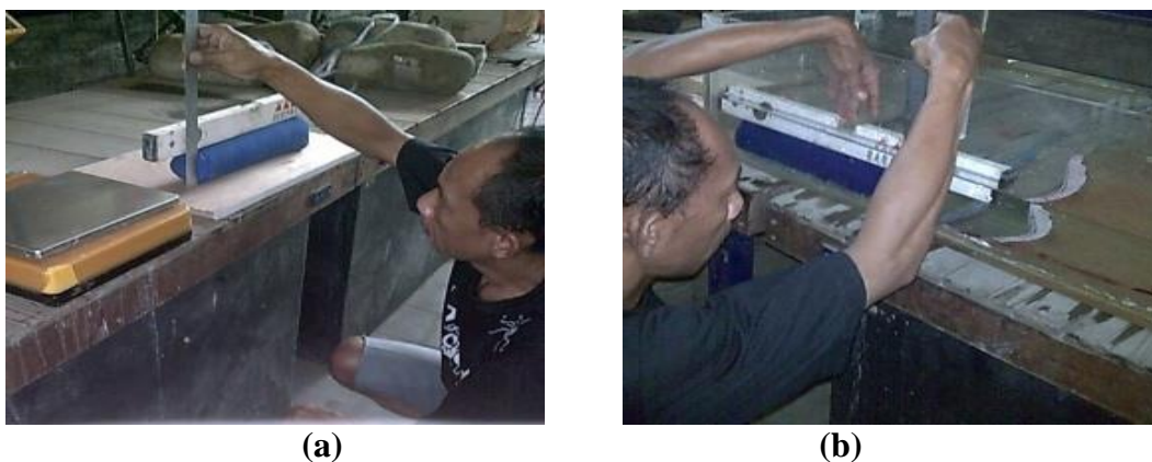
Gambar 4. (a). Pengukuran dimensi struktur di udara, (b). Pengukuran dimensi struktur terendam.
