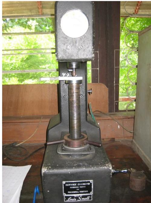
**Gambar 10. Alat pengujian kekerasan dengan metode Rockwell B, Louis Small**
