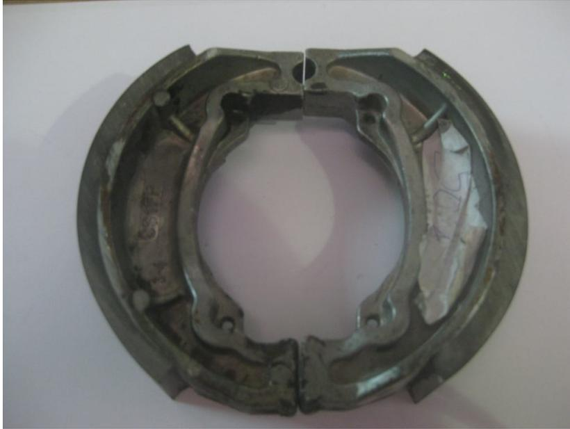
**Gambar 12. Spesimen kampas rem tromol.**
