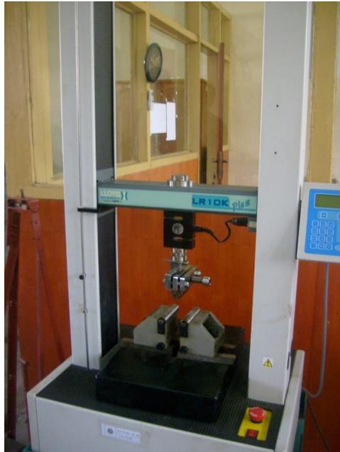
**Gambar 8. Pemasangan spesimen pada alat uji lentur.
