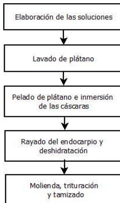
Figura 2 Diagrama de Flujo para la obtención de almidón de cáscara de plátano
