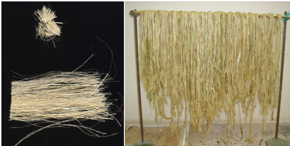
Figura 3.2 - Fibras de Caroá obtidas de forma manual.
