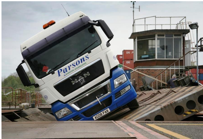
Figura 10. “Tilt Table” para o obter o Limiar Estático de Tombamento.
