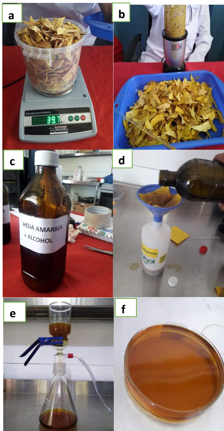
Fig. 09. a) Pesado de hojas amarillas de Azadirachta indica . b) Molido de las hojas en el Magic Bullet. c) Maceración del extracto obtenido. d) Primer filtrado del extracto. e) Segundo filtrado del extracto con sistema al vacío. f) Vertido del extracto filtrado en placa Petri para la evaporación del etanol.
