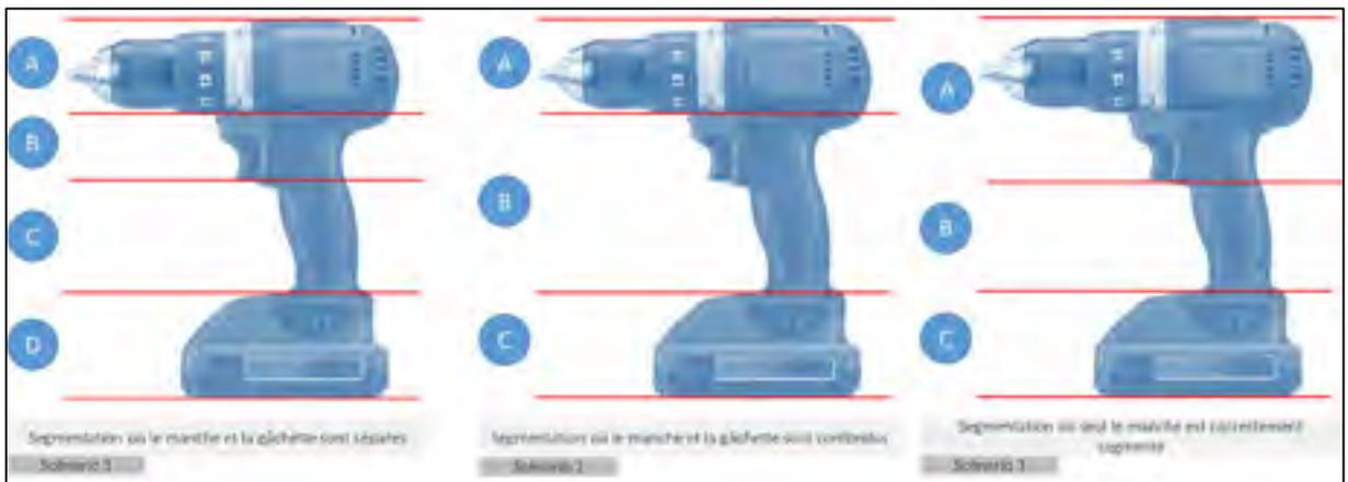
Figure 3.27 : Scénarios possibles de segmentation sur le manche et la gâchette
