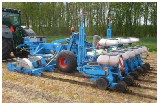
Figuur 27. Machine voor strokenfrezen en zaaien in één werkgang, variant 3
