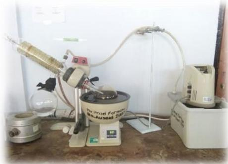
**Gambar 7. Pemekatan Ekstrak dengan *rotary evaporator***
