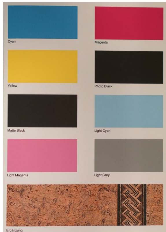
Abbildung 25: Ausdruck mit acht Pigmenttinten und der Testrekonstruktion
