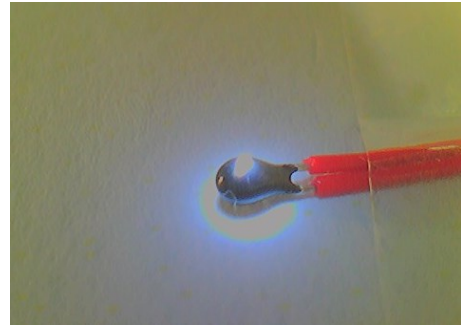
Abbildung 8: Temperatursensor im Fokus des MFT
