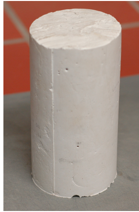
Abbildung 8.1: Silikonzylinder zur Überprüfung der Abweichung bei der Volumenbestimmung
