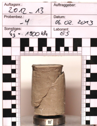
Abbildung 5.25: Aufbereitete Probe von Ton 2 nach der Scherung
